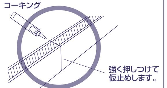
④ 連続して使用する小口や継ぎ目、外壁材との隙間は、必ずコーキング処理をしてください。隙間があると雨水浸入の原因になります。
