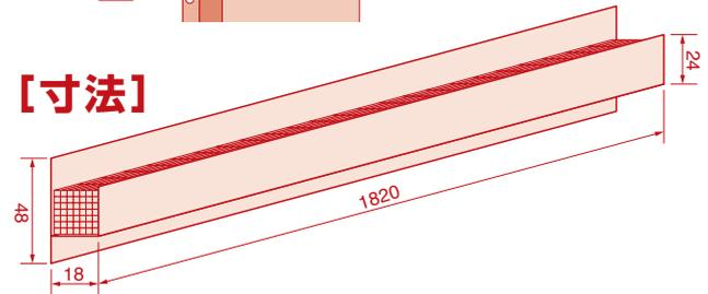
アルミニウム-亜鉛合金めっき鋼板+3次元不織布+加熱膨張材
