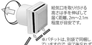
※パチットは、別袋で同梱していますので、完了後忘れずに取り付けてください。
