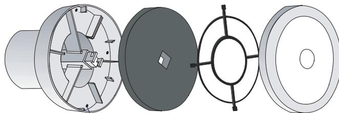
カバー、フィルターを外し4カ所をビス止めします。
