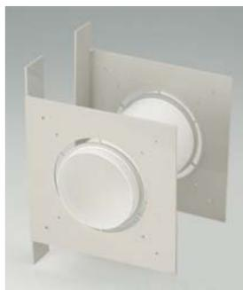
埋め込み用にスリーブ管を使用する場合は塩ビライト管85(市販品)を壁の厚みに応じて埋め込みます。(水が流れ込まない様、外側に向けて勾配をつけて下さい。)
