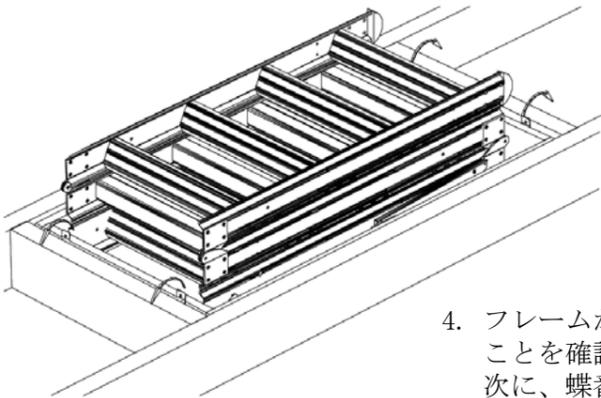
4. フレームが天井面に対して垂直になり、開口部に跳ね上げ戸が水平であることを確認してください。次に、蝶番が付いた側から先に始めて合わせます。上向きに跳ね上げ戸を押し込むように、スプリングを固定します。同様に反対側のスプリングを続けて固定してください。
