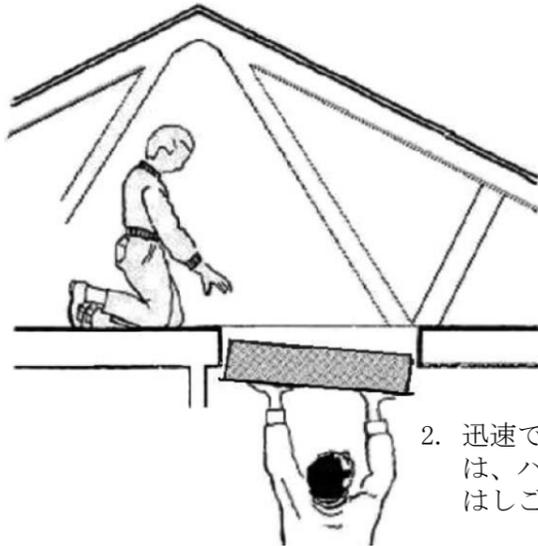
2. 迅速で安全な作業を行うには最低2名の作業員が必要になります。ひとり、ハンマー、スクリーブス、ドライバー、および固定材料を持ち、はしごを使って小屋裏に上がります。
