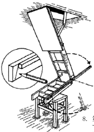
8. 第2関節下の端部に定規を合わせ、はしごの最も低い部分と定規を合わせます。次に、はしご下部の側面に、定規の印と長さを合わせて印を付けます。床の角度に合わせ直線を引きます。端40mmは調節として線を加えています。
