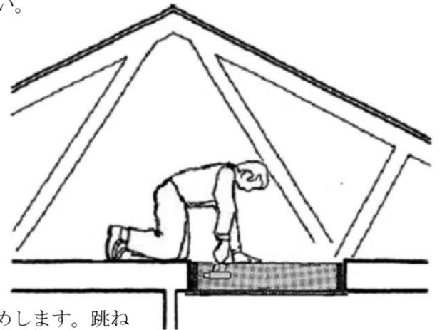
5. 慎重に跳ね上げ戸を開けてください。次に、開口部の内側からスクリーブスでフレームに仮留めします。跳ね上げ戸が水平で、ねじれがなく、容易に開閉することを確認してください。最終的に、スクリーブスで全周を固定します。
