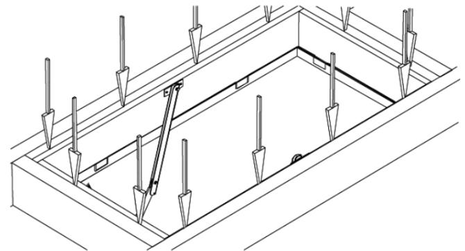
6. フレームと床材の段差を処理してください。次に額縁が天井面に接着するようにシーリングします。また、表面にクロスを張ることもできます。
