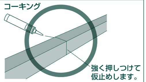
④ 連続して使用する小口や継ぎ目、外壁材との隙間は、必ずコーキング処理をしてください。隙間があると雨水浸入の原因になります。
