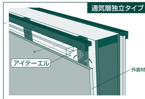
③外装材を並行して施工している場合は、上部に仮留付けます。
