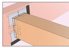
応用方法として、柱や梁の気密カバーとしても利 用できます。柱寸法に合わせてカットすることで、 さまざまな寸法に調整できます。
