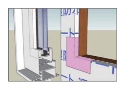
サッシ取付前にコーナーセイバーを防水気密 テープで固定します。その上からサッシを止め
