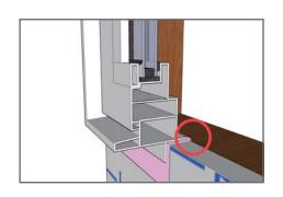
サッシを取り付ける際、5mmの水返しが立ち上 がるようにします。
