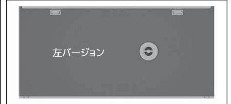
図4: ドレン管接続位置 左バージョン
