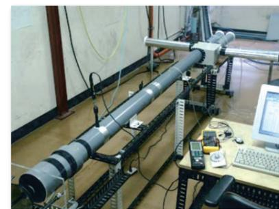
北見工業大学坂本志志名誉教授指導のもとすべての部材の圧力損失抵抗を計測し、換気システム用配管シミュレーションプログラムを開発。より正確な風量コントロールが可能になりました。
